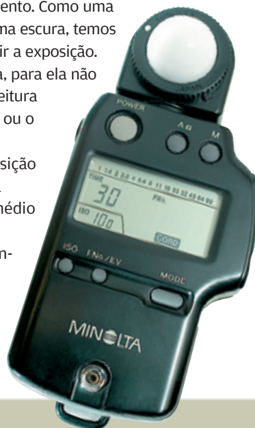
Fotômetro externo: ajuda a medir a luz refletida e a emitida
