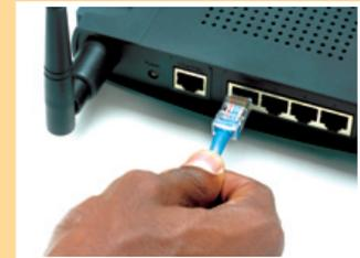
**b** Pegue o cabo de rede que vem solto com o roteador e conecte-o, em uma das quatro saídas dele, numa ponta e, na outra ponta, à placa de rede do PC
