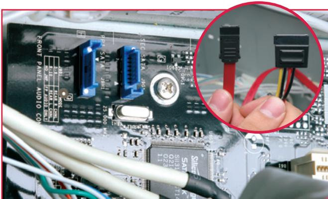
Portas SATA na placa-mãe e cabos de dados e de força (detalhe)
