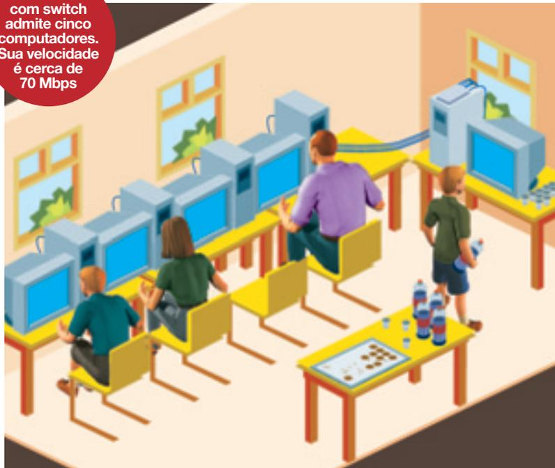
um arranjo básico com dois computadores rodando Windows XP. O switch usado para conectá-los tem cinco portas, de modo que mais três colegas podem trazer seus PCs e ligá-los nelas. Se você achar que isso é pouco, é só trocar o switch
