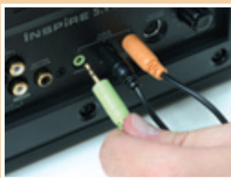
e Plugue o cabo de três pinos nas entradas do subwoofer
