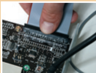
b No painel, você deve ligar os cabos FireWire e AUD_EXT
