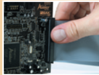
c Depois de fixar o painel no gabinete, ligue os cabos à placa
