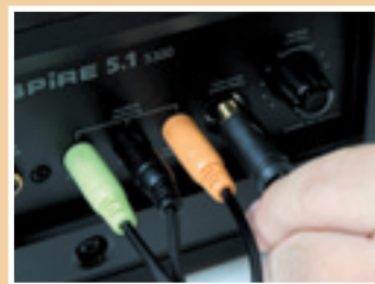
f Em seguida, ligue o cabo do controlador de volume
