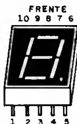
PINAGEM DO DISPLAY FND500 Figura 11
