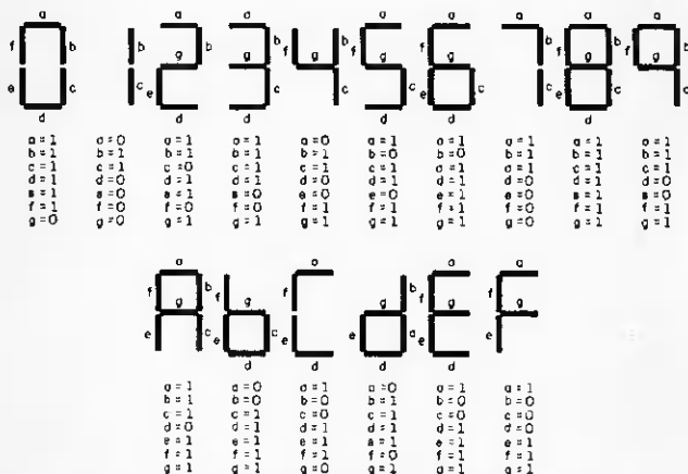
FORMAÇÃO DOS CÓDIGOS DE 7 SEGMENTOS A PARTIR DO NÚMERO VISUALIZADO NO DISPLAY
