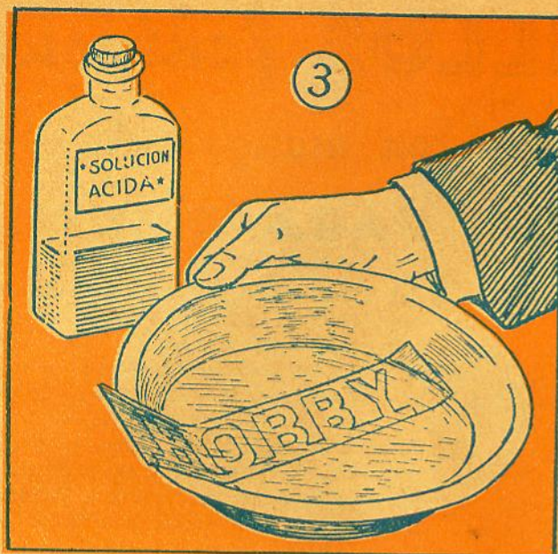
Fig. 3. — Una vez hecho el dibujo a través de la capa de cera, el metal queda listo para el baño ácido. Se usa una solución especial que asegura acción uniforme; su acción es lenta, pero mucho más eficaz que las comúnmente recomendadas para el mismo objeto.
