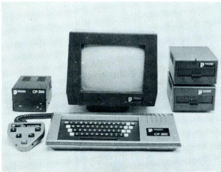
Foto 5A - Fonte de alimentação, joycontrol e D 300, acoplados ao CP 300.
