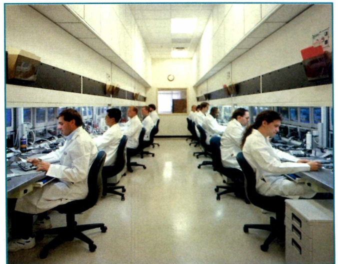
Sala onde os HDs são manipulados. Nessas salas esterilizadas, HDs com defeitos físicos podem ter alguns dados recuperados.
