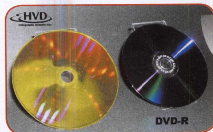
O HVD tem o mesmo tamanho de um DVD (à direita), mas armazena dados em forma de hologramas
