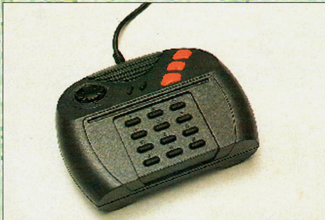
Dos 17 botões, 3 são para tiro, 2 para seleção e 12 formam um teclado cujas funções são explicadas quando se introduz uma ficha plástica
