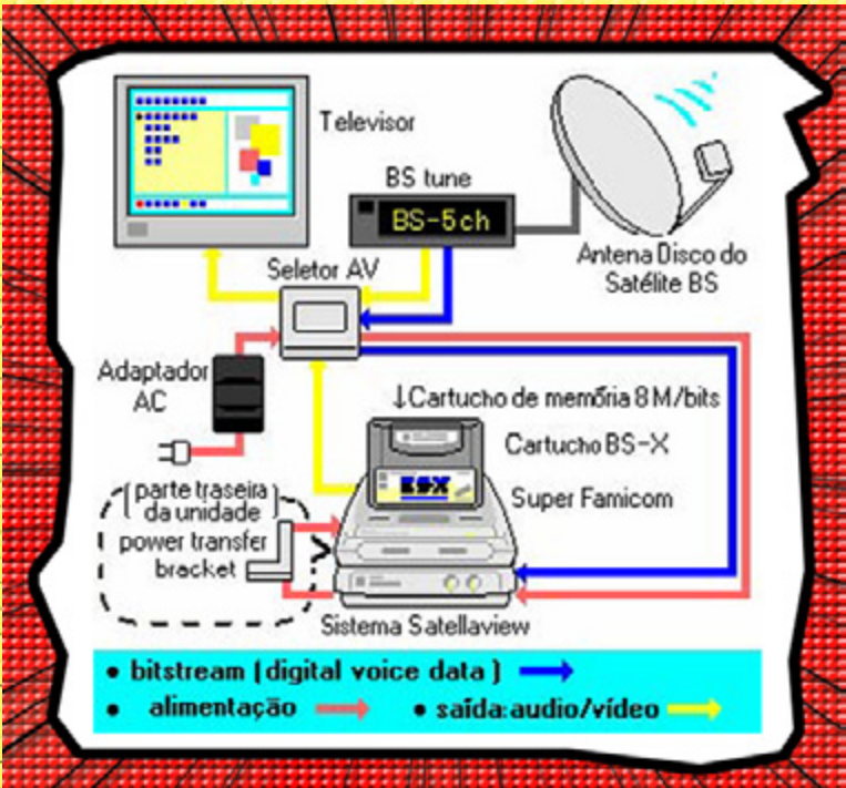
Esquema do manual de instruções do Satellaview (traduzido) de como funcionava o periférico desde suas ligações com a TV até o esquema de como os dados eram recebidos via satélite.
