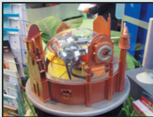
◀ Компьютер на плате формата Nano-ITX от VIA легко умещается даже в корпусе часов!
