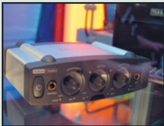
◀ Звуковая карта от Terratec во внешнем исполнении с FireWire-интерфейсом, 7.1-канальным аналоговым выходом, дистанционным пультом и оригинальным дизайном.
