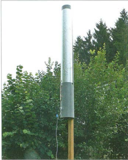
Bild 3: Bei Erhöhung des „Mindestabstands“ zur Erde hin ergibt sich keine signifikante Kapazitätsänderung, siehe Text.
