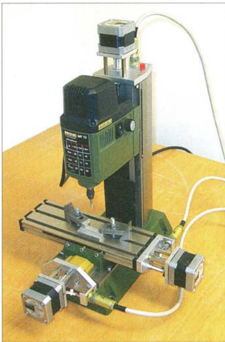
Bild 1: Komplett aufgebaute CNC-Fräse ohne Abdeckungen für X/Y-Antriebe
