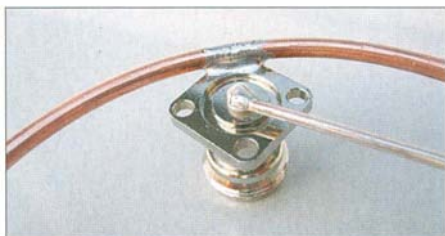
Bild 2: Lötverbindung von N-Buchse und Strahlerritte sowie Anschluss der Gamma-Leitung
