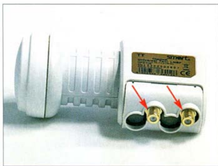
Bild 4: Ein solcher Twin-LNB eignet sich zum direkten Anschluss zweier Sat-Receiver. Jeder der beiden Ausgänge stellt vertikale und horizontale Signale des Low- sowie des Highbandes bereit. Eine Weiterverteilung auf mehr als zwei Receiver ist nicht möglich.
