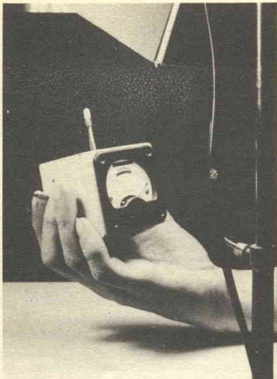
Il fotometro avvicinato ad un proiettore ad infrarossi
