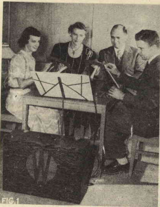
FIG. 1 Ciascuno dei suonatori ha dinanzi una delle sezioni dello strumento elettronico, la cui parte comune si trova nella cassetta in primo piano che contiene anche l'altoparlante. Lo strumento può essere suonato come spartito, come nel caso illustrato nella foto, sia ad orecchio, sia ad improvvisazione o ad arrangiamento.
