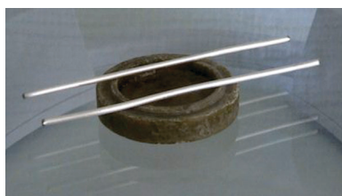
Figura 1: Bacchette in argento purissimo ed il tappo di gomma per realizzare la sonda
