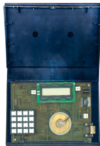
Figura 11: Prototipo assemblato entro un contenitore per video-cassetta
