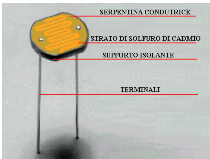
Figura 1: Struttura di una fotoresistenza
