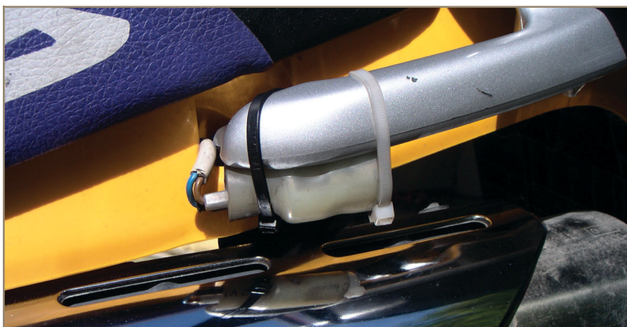
Figura 3: Montaggio della presa accendisigari sulla moto
