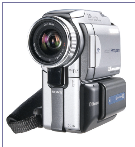
Figura 3: Le telecamere digitali dispongono normalmente di una uscita digitale firewire e di altre uscite video analogiche.
