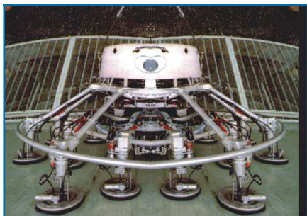
Figura 6: Legged walking robot con dodici zampe
