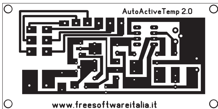
Figura 3: : Circuito stampato e posizionamento componenti del circuito 1.0
