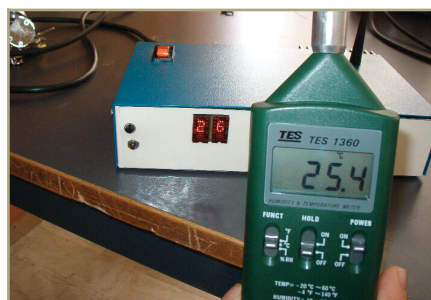
Figura 22: Fase di taratura e verifica della stazione di rilevamento/visualizzazione tramite termometro campione
