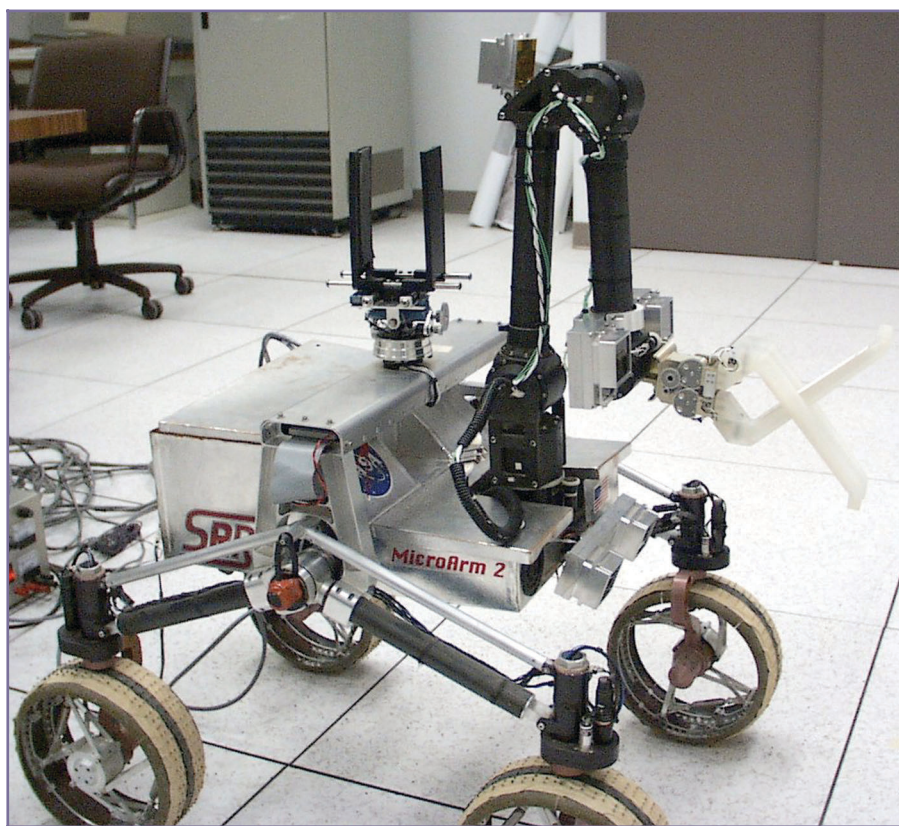
Figura 9: Il Robot Work Crews afferra gli oggetti e li trasporta cooperando con altre unità simili
