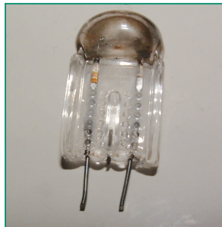
Figura 25: Lampada HQI 70W non ancora montata
