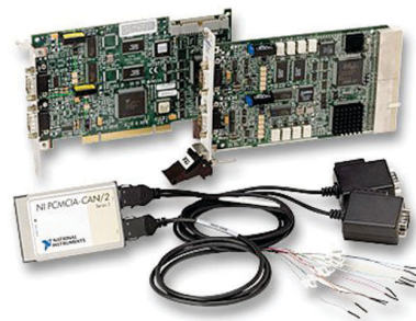
Figura 5: Schede della National Instrument per l'interfacciamento al PC di reti CAN
