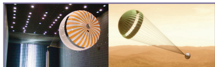
Figura 4: La grande galleria del vento nella quale si sono compiuti i test sul paracadute, decisivi per il corretto funzionamento nell'atmosfera di Marte
