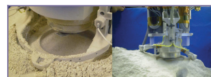
Figura 10: L'utensile abrasivo permette di eliminare gli strati esterni della roccia e consente la successiva analisi degli strati più interni
