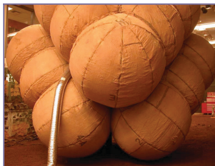
Figura 5: Gli airbag utilizzati per ammorbidire l'atterraggio del rover, in un test compiuto sulla Terra
