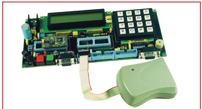
Foto 3: Scheda di Test GMM TST2 con montato un GMM AM08 e collegata al programmatore Atmel AVR ISP
