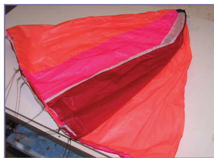
Figura 6a: Verifica dell'integrità del paracadute
