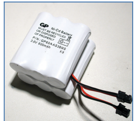
Figura 7: Le due batterie della GP che provvedono all'alimentazione
