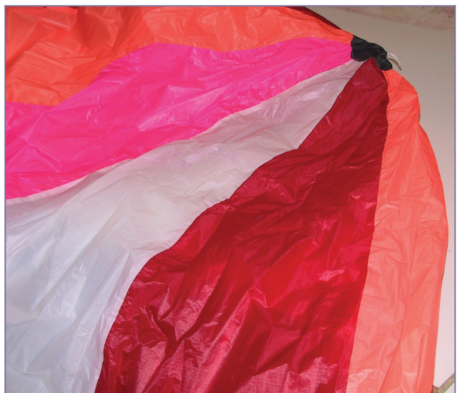
Figura 9: I ferzi cuciti danno forma al paracadute
