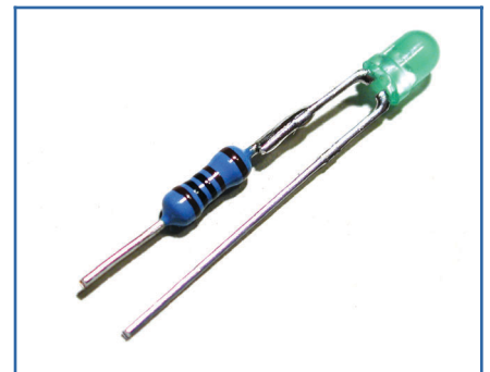
Figura 8: Il LED con la resistenza da 1K saldata
