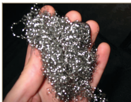
Figura 3: Lo scambiatore di calore: la lana d'acciaio
