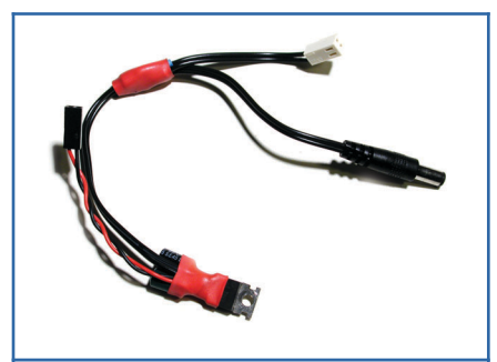
Figura 30: I cavi saldati e completati con la guaina termoretraibile
