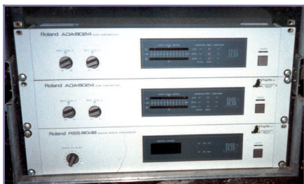
Figura 4: Il cuore del sistema RSS era formato da moduli rack componibili in base alle necessità; i dati venivano impartiti dal controller ed elaborati in tempo reale
