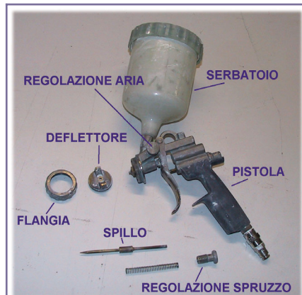
Figura 14: Componenti di un comune aerografo
