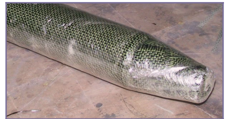
Figura 11: L'ogiva pronta per la laminazione
