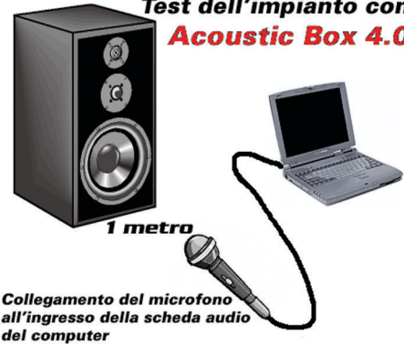
Figura 5: Lo schema mostra come utilizzare Acoustic Box 4.0 per testare efficacemente il diffusore progettato
