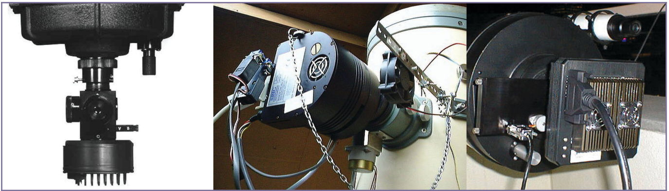
Figura 2: In questi CCD spiccano le alette di raffreddamento e le ventole utilizzate per dissipare il calore prodotto dalle celle di Peltier. I sensori vengono portati a temperature che possono essere anche di 30° inferiori rispetto alla normale temperatura dell'ambiente
