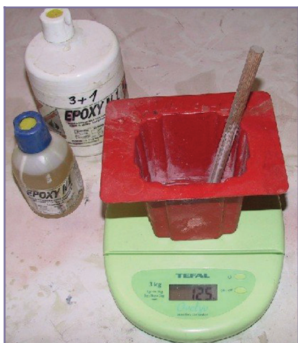
Figura 4: Preparazione della resina
