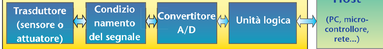
Figura 2: Schema a blocchi di un sensore intelligente di prima concezione
