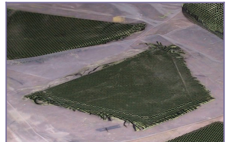
Figura 12: Costruzione delle pinne stabilizzatrici
