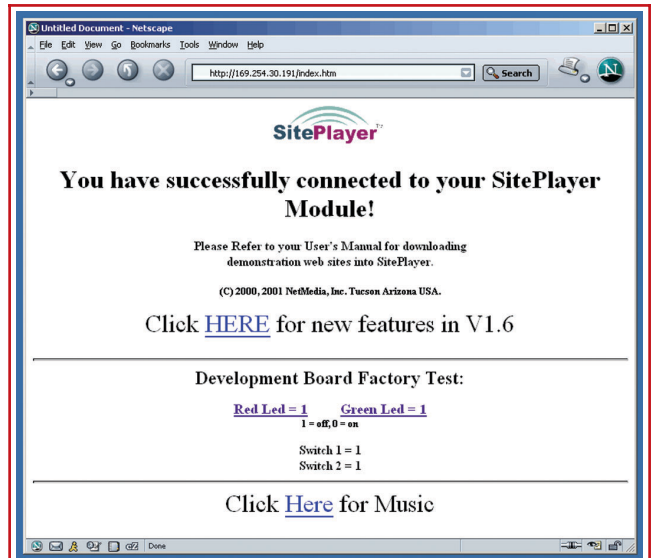
Figura 3: Ecco la schermata che si presenta la prima volta che si effettua una connessione al modulo SitePlayer. Clickando sui link "Red Led=1" e "Green Led=1" si accendono o spengono i LED presenti sulla scheda di sviluppo SPK1. Clickando su "Click Here for Music" inizia a suonare un file musicale .mid presente nella memoria del SitePlayer
