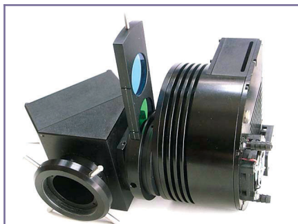
Figura 7: Lo specchio diagonale è attivo ed è in questo caso collegato ad un CCD dotato anche di una slitta per filtri colorati. Sul CCD si notano i beccucci per l'attacco dei tubi del sistema di raffreddamento a liquido
