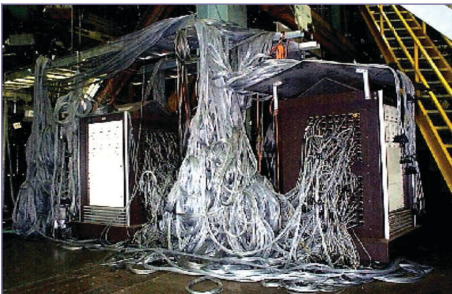
Figura 1: Sistema della Boeing per test alla fatica statica di un F18. Questo è solo uno di un totale di 5!
