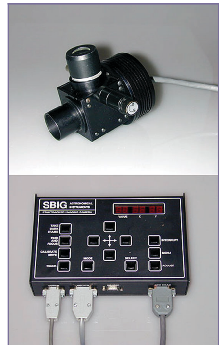
Figura 7: Un sistema di autoguida formato da CCD e da relativa centralina di controllo da collegare al telescopio
