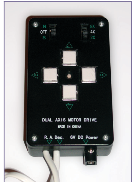
Figura 1: Una tra le pulsantiere più diffuse a livello amatoriale. Collegate ai motori passo-passo di entrambi gli assi del telescopio, questi circuiti dotati di microcontrollore provvedono a gestire il "moto AR" e grazie ai 4 tasti permettono di spostare lo strumento con diverse velocità
