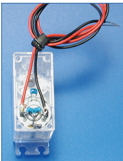
Figura 18: Installazione dei 3 condensatori per ridurre le interferenze generate dalle spazzole del motore
