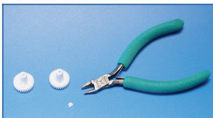
Figura 17: L'operazione di taglio dell'aletta di blocco della rotazione
