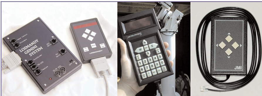
Figura 3: Il mercato offre diverse soluzioni per poter automatizzare il proprio telescopio. Molte pulsantiere dispongono anche di una interfaccia seriale per il collegamento al PC per gestire graficamente tutti i parametri e le diverse funzioni
