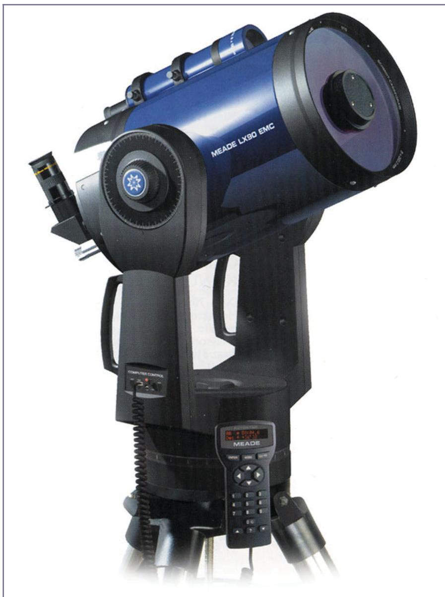
Figura 4: Un classico modello da 20cm di diametro, dotato di "computer di bordo" e di pulsantiera con sistema di puntamento. La montatura che lo sorregge è di tipo a "forcella" e dentro di essa sono posizionati gli encoder, i motori e la parte elettronica
