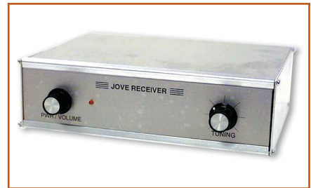
Figura 9: Il ricevitore in Kit del progetto "RadioJove". È dotato di una manopola di sintonia fine che consente di spostare la ricezione di qualche KHz rispetto alla frequenza fissa di lavoro (20 MHz). Tale accorgimento permette l'uso dell'apparecchio anche in caso di eventuali interferenze terrestri sulla frequenza base
