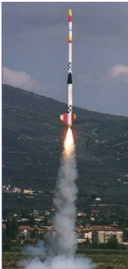
Figura 2: Decollo di un vettore da 3 metri spinto da un motore composito
