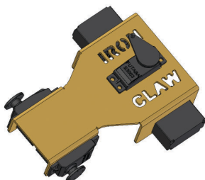
Figura 4 Disegno 3D avambraccio con servocomandi
