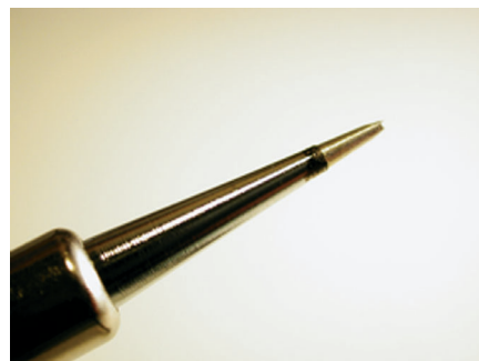
La punta di un saldatore pulita e in buono stato. Figura 1b
