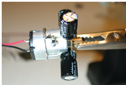
Figura 12 Introduzione del motore nell'alloggio e saldatura.
