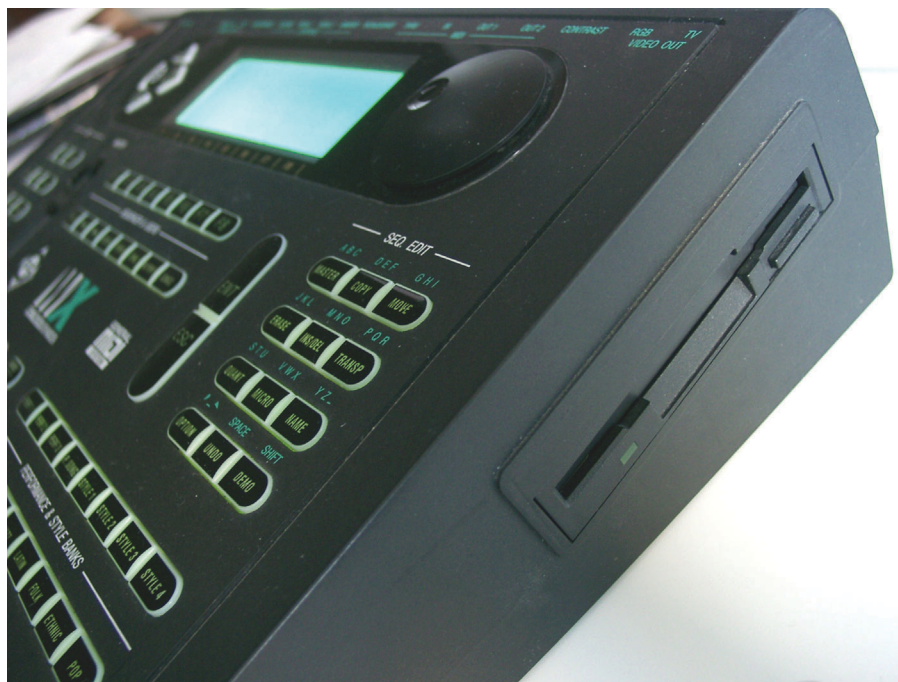
Il lettore floppy-disk permette la lettura dei MIDIfile.
