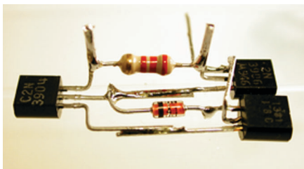
Figura 9 Saldare la resistenza, il circuito e' terminato.
