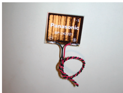
Figura 16 Saldatura del cavetto alla cella solare.
