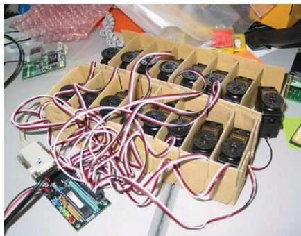
Il controller POSSC collegato a 16 servo Futaba S3003
