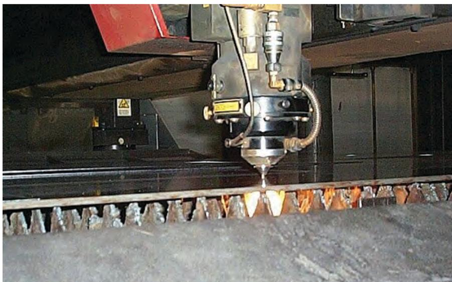
**Figura 1** Nella foto possiamo vedere una classica testa di taglio laser Flying Optician (Ottica Volante) in azione.
