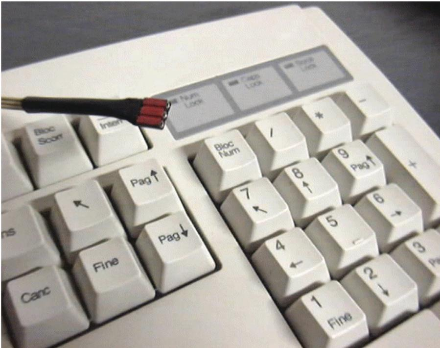
Figura 6 Connettore in guaina termoresistente.
