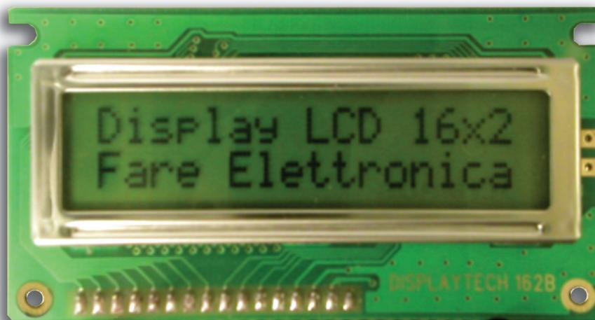
Figura 1 Il display 16x2 utilizzato.
