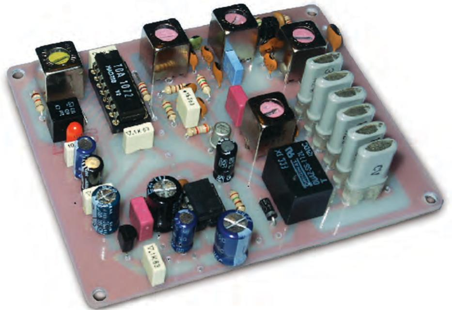
hanno consentito di stabilire in 6,8pF, la capacità necessaria a fare risuonare i primari di tali bobine in gamma 27 MHz. La sezione oscillatore locale (TR 1) può funzionare selezionando i quarzi XR1-XR6 ma anche come VFO; questa funzione, attivabile tramite il relè 1, consente di esplorare l'intera gamma CB. Anche la bobina del VFO è una FM1 mentre per la
