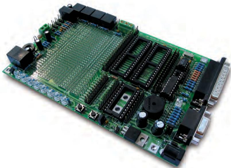
La scheda di sviluppo BXDS (BasicX Development Station) La scheda di sviluppo BXDB (BasicX Demo Board) **Figura 3**
