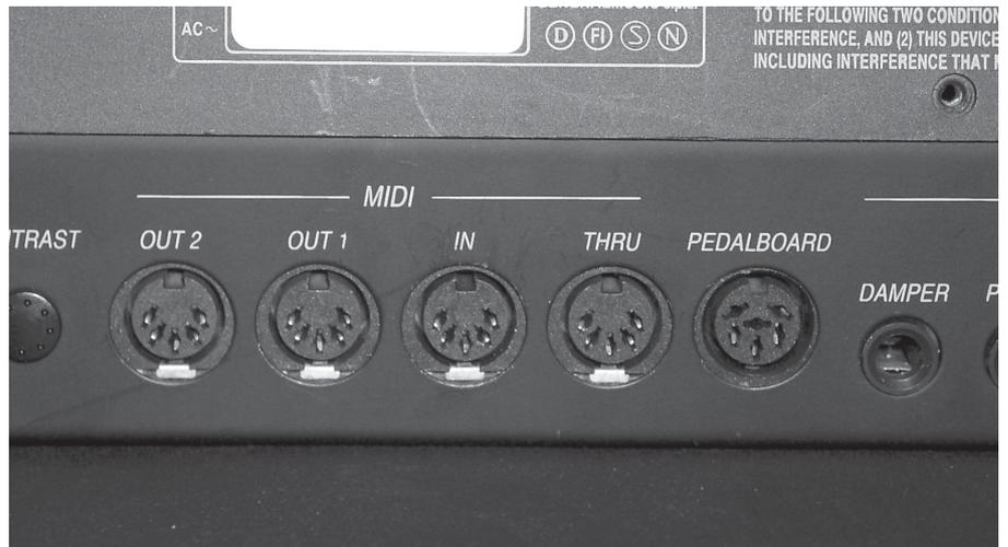
**Figura 2** Il pannello posteriore con i classici connettori MIDI. In questo caso, la tastiera dispone di due uscite indipendenti (out1 e out2).
