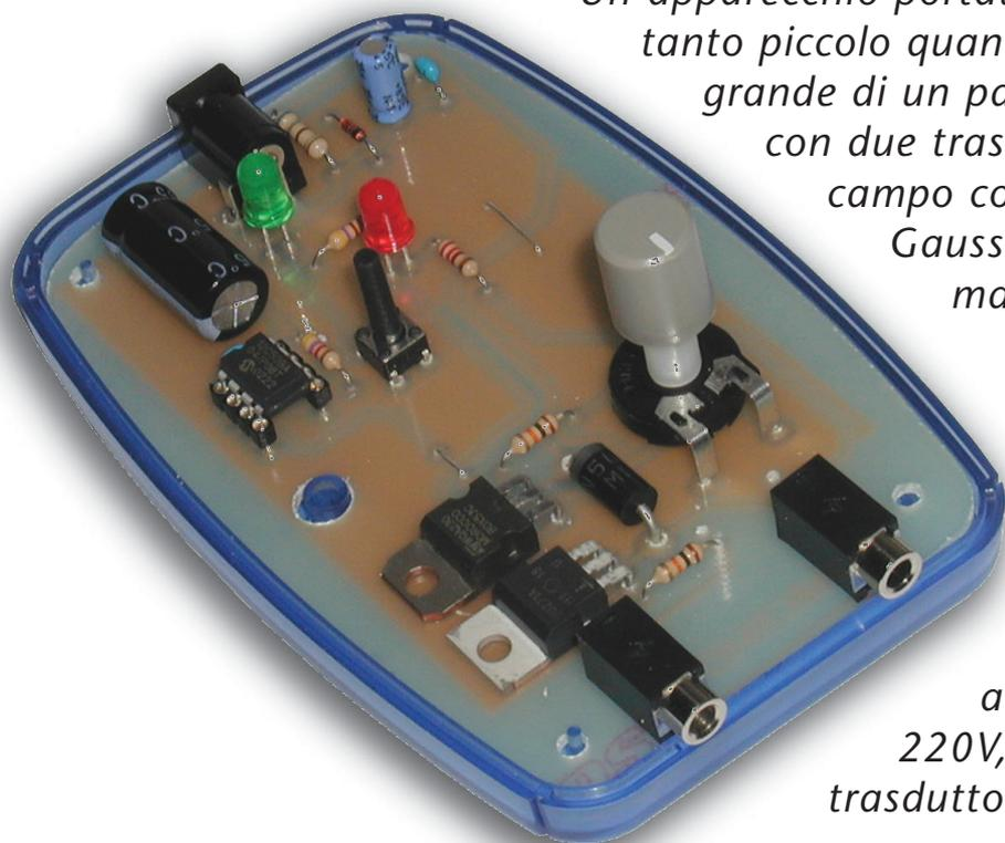
*Un apparecchio portatile per magnetoterapia, tanto piccolo quanto efficiente. Poco più grande di un pacchetto di sigarette, con due trasduttori magnetici a campo concatenato, oltre 100 Gauss di campo magnetico massimo, frequenza a variazione ciclica continua (70-75-80 Hz), e timer preimpostato a trenta minuti. Il kit è già comprensivo di alimentatore da rete 220V, contenitore, e due trasduttori magnetici.*
