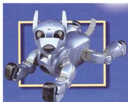
Il Cane Robot I-CYBIE si comanda tramite comandi Vocali, Battito delle Mani o tramite Telecomando a raggi infrarossi.
