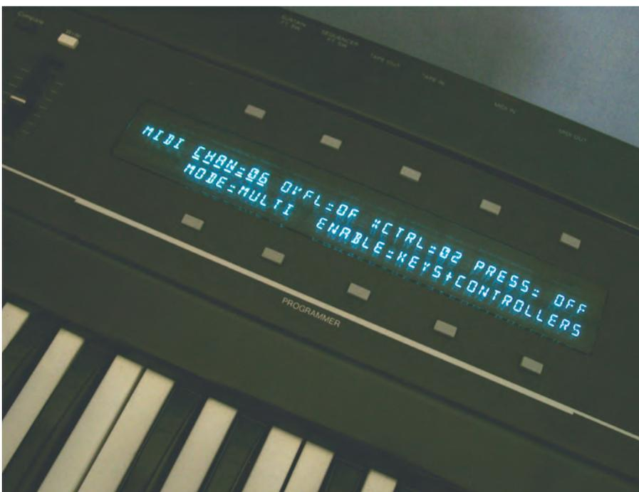
Particolare del display con evidenziati i parametri di controllo delle porte MIDI. **Figura 1b**
