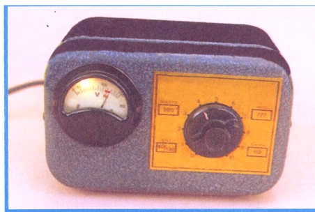
Figura 27-Aparência de um antigo regulador de voltagens comercial.
