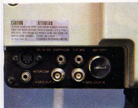
ACIMA: conexão genlock para sincronizar várias câmaras.
