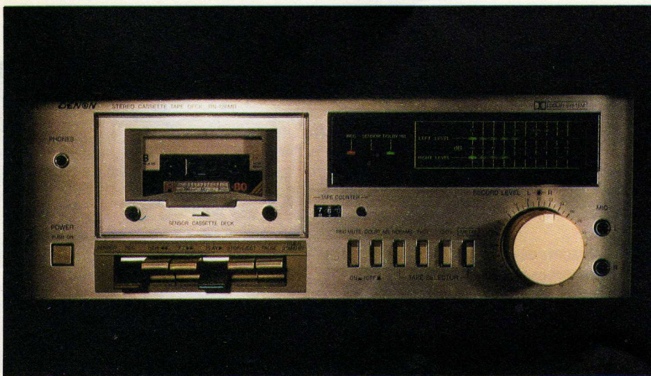
ABAIXO: durante a gravação, é fundamental controlar a quantidade de sinal que chega aos cabeçotes. Para isso, recorre-se aos indicadores de nível.
