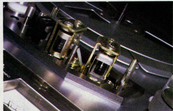
ABAIXO: em alguns gravadores de carretel, aplica-se a pré-magnetização de um cabeçote, localizado em frente ao cabeçote de gravação, ao outro lado da fita. Esse processo de polarização é conhecido como campo cruzado (cross field).
