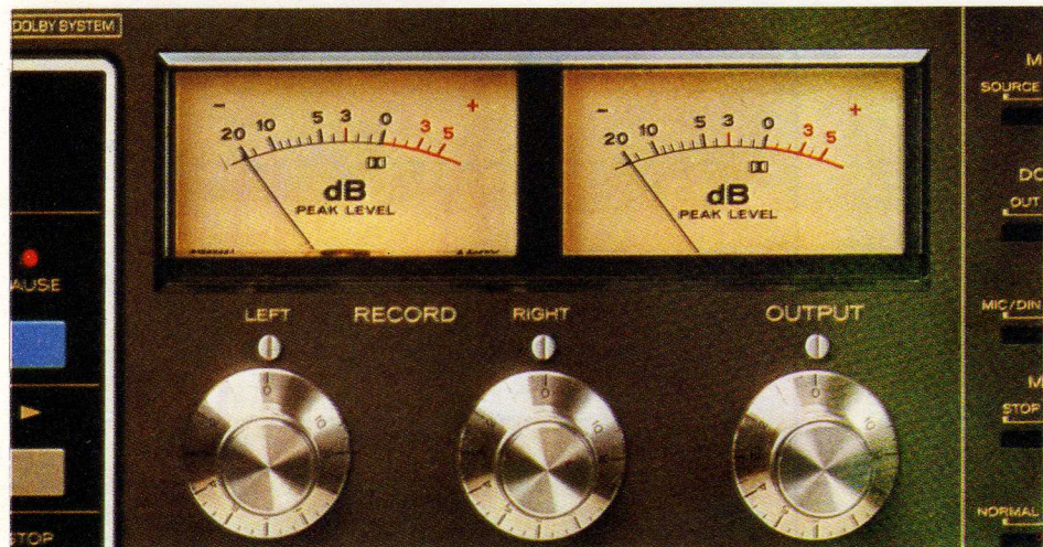
ABAIXO: antes de começar uma emissão de FM-Dolby, faz-se o aparelho emitir um tom. Com ele, calibra-se a agulha do indicador na posição Dolby. Dessa forma, assegura-se que a fita não será saturada durante a gravação do programa emitido.
