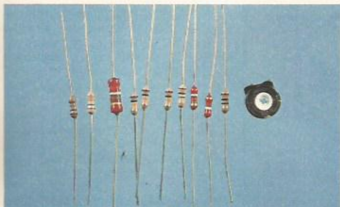
1. Resistores necessários para a montagem do aparelho, alinhados de R1 a R10, da esquerda para a direita. Junto a eles, está o trim-pot P1.
