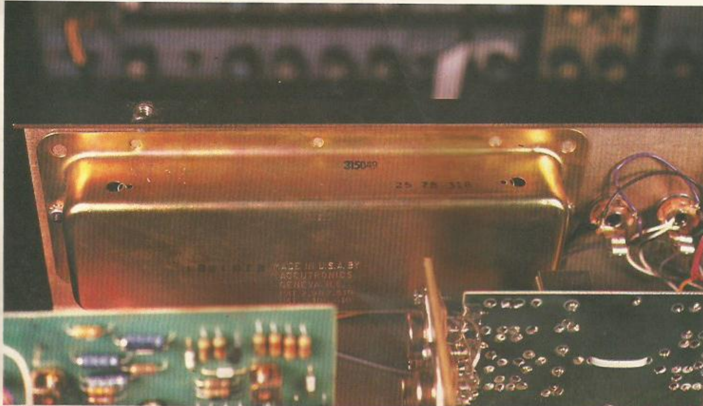
ABAIXO: unidade de reverberação com base em elementos elásticos.
