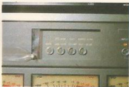
ACIMA: os comandos do gravador permitem o controle de suas funções, como, por exemplo, a introdução de um sistema de redução de ruído de fundo.
