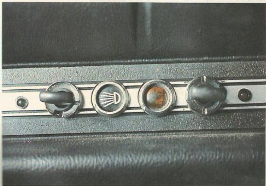
11. Esta é a posição escolhida para os led indicadores. A montagem é feita executando-se dois furos no painel e usando-se duas buchas de plástico para fixação.
