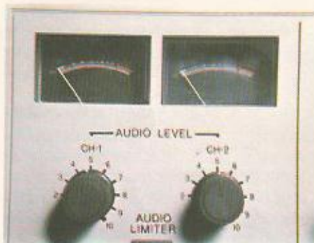
ACIMA: detalhe dos VUs de áudio em um U-Matic. Os dois canais podem ser utilizados independentemente para o áudio (um para cada trilha).
