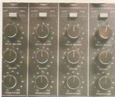
ACIMA: é importante que uma mesa tenha a possibilidade de se monitorizar ou de pré-escutar os sinais que passam por ela.
