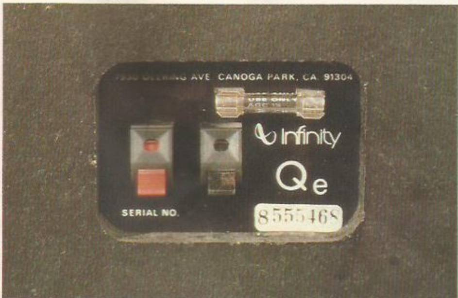
ABAIXO: os fusíveis podem dar uma razoável proteção à caixa. O inconveniente de sua utilização é que eles queimam quando é superada a margem de segurança, devendo ser trocados por outros com igual corrente de fusão.
