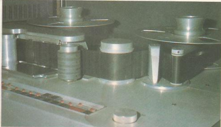
ABAIXO: as fitas magnéticas utilizadas em equipamentos de gravação são, na maioria, de óxido de ferro. Sua largura costuma ser de 2" (5,08 cm).
