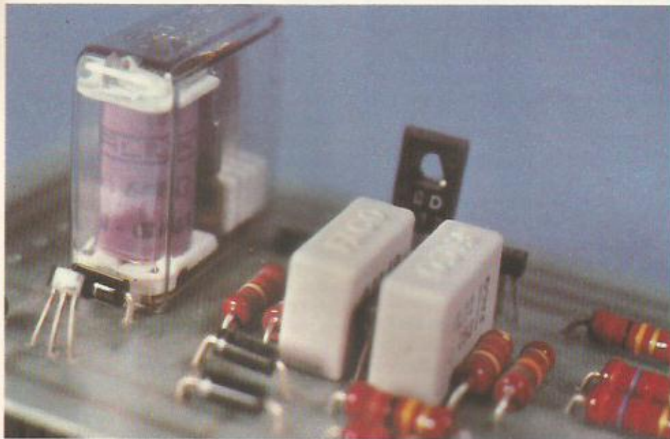
ACIMA: um relê é um componente eletromecânico que pode controlar alguns contatos elétricos, através dos quais passa o sinal que é enviado às caixas.
