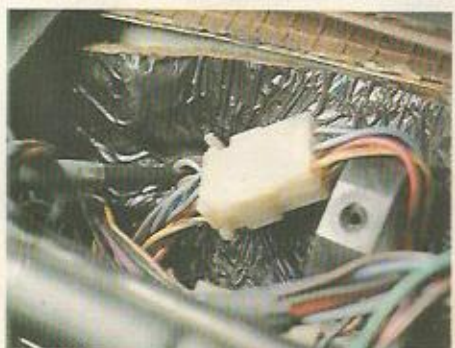
11. A foto mostra o conector com os dois cabos que enviam a tensão de excitação aos dois grupos de pisca-piscas. O aparelho deverá ser ligado a esses cabos.
