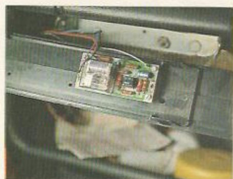
10. Este aparelho pode ser instalado em qualquer local no interior do automóvel, mas distante do motor, por não dispor de uma caixa de proteção.
