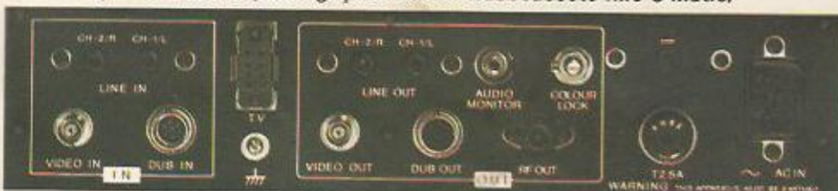
ABAIXO: painel traseiro para ligações de um videocassete fixo U-Matic.
