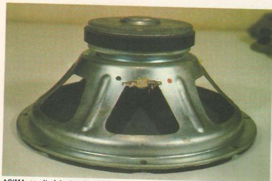
ACIMA: os alto-falantes de qualidade possuem terminais marcados para que se reconheça qual é o positivo e qual é o negativo. Essa nomenclatura é convencional e só é utilizada para que as ligações sejam feitas de forma correta.
