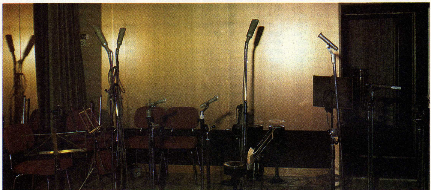
ACIMA: os estúdios para gravação dos instrumentos de corda devem ter uma acústica viva.
