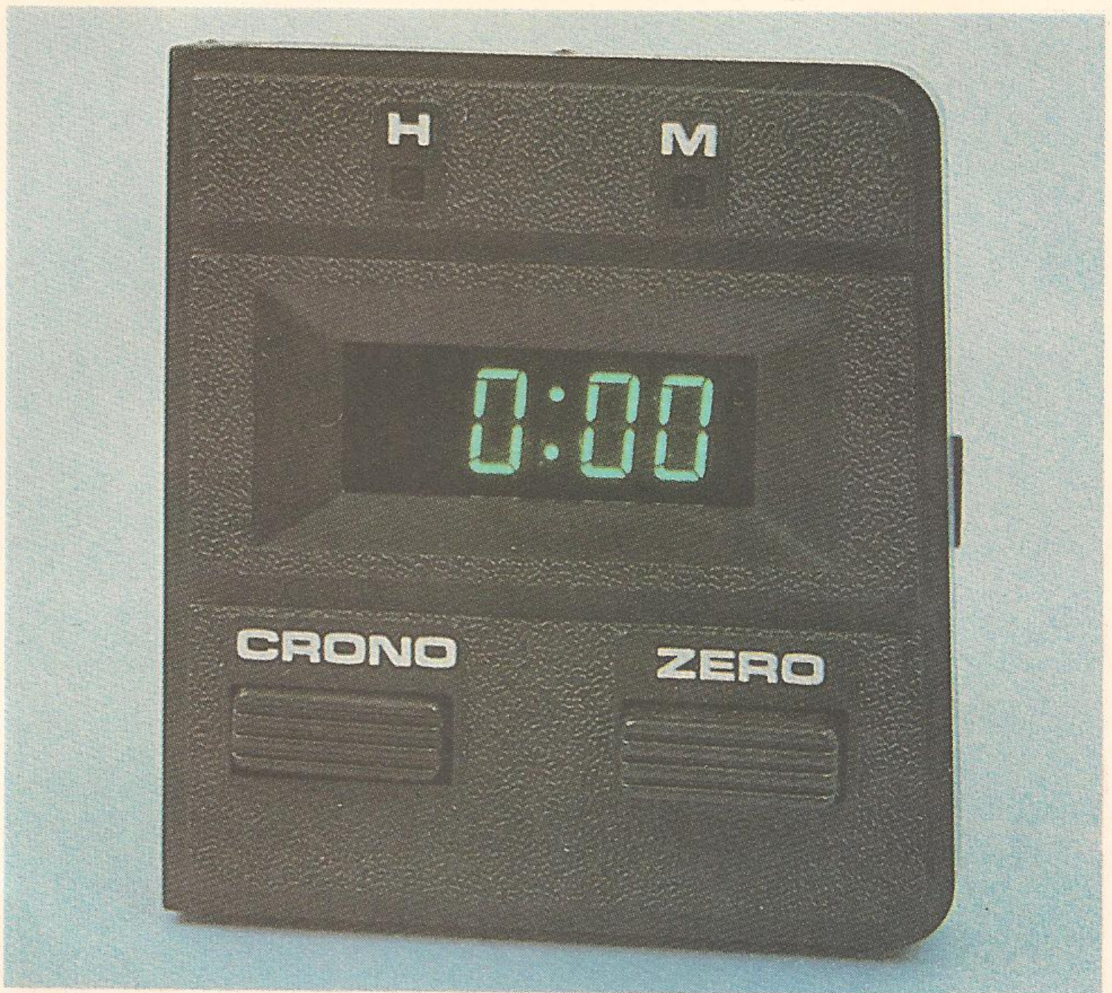
3. Com a tecla CRONO apertada, um leve toque na tecla ZERO provocará a zeração do cronômetro.
