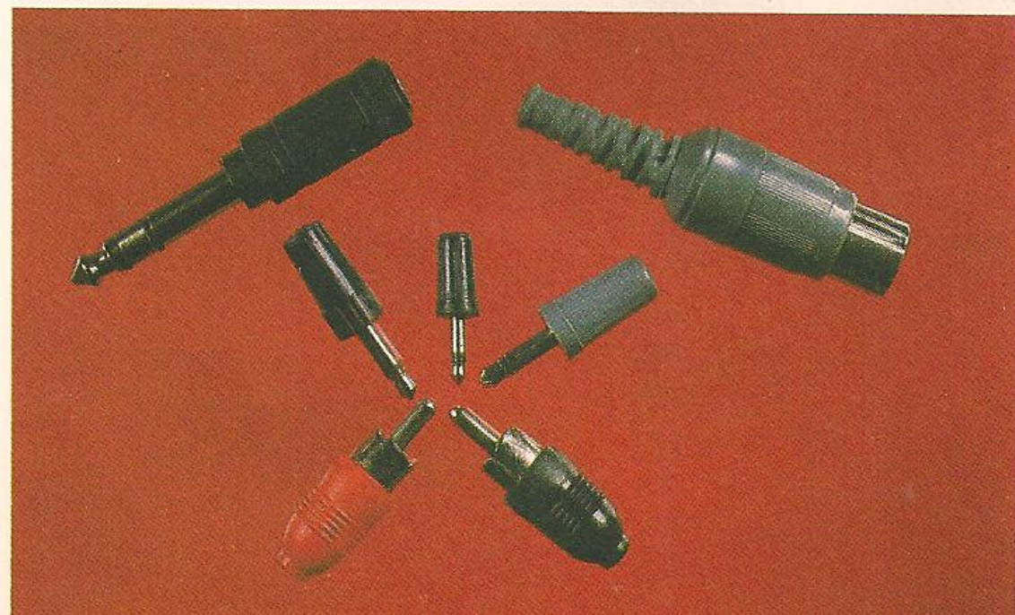
ABAIXO: três tipos de conectores machos para transmissão de sinais.
