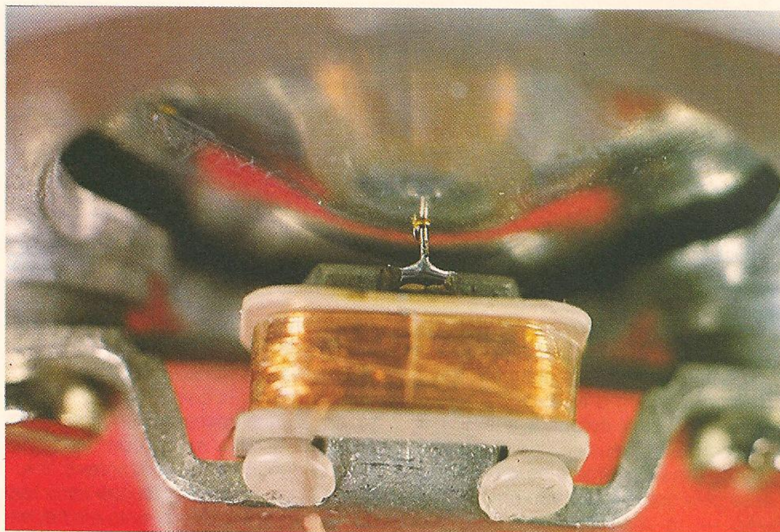
ACIMA: detalhe da ligação mecânica entre os pólos e o diafragma (na parte superior), em um fone de ouvido magnético.
