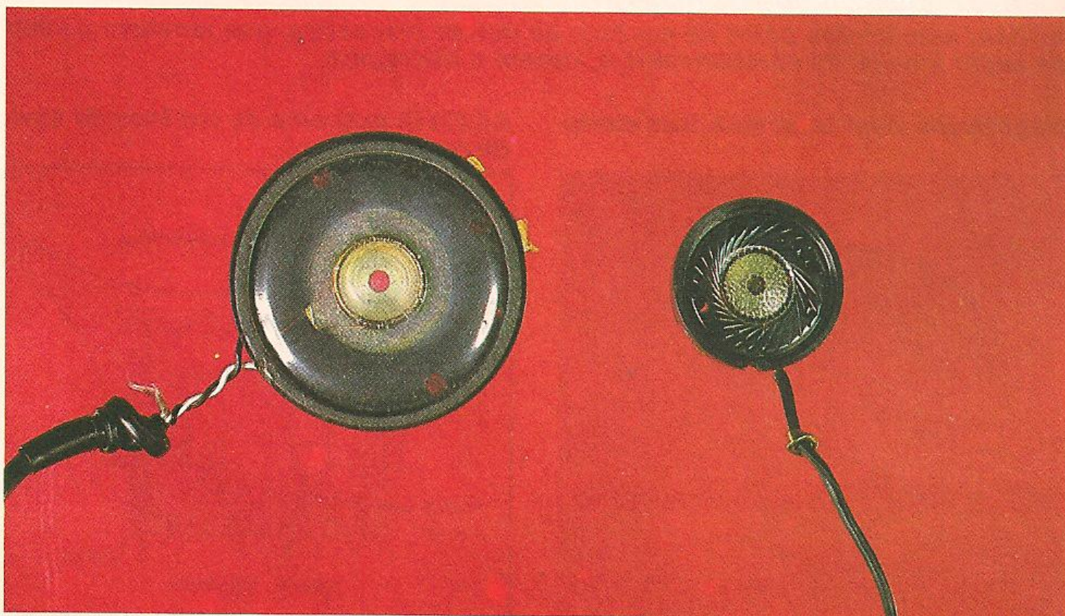
ABAIXO: dois modelos de cápsulas para fones de ouvido dinâmicos.
