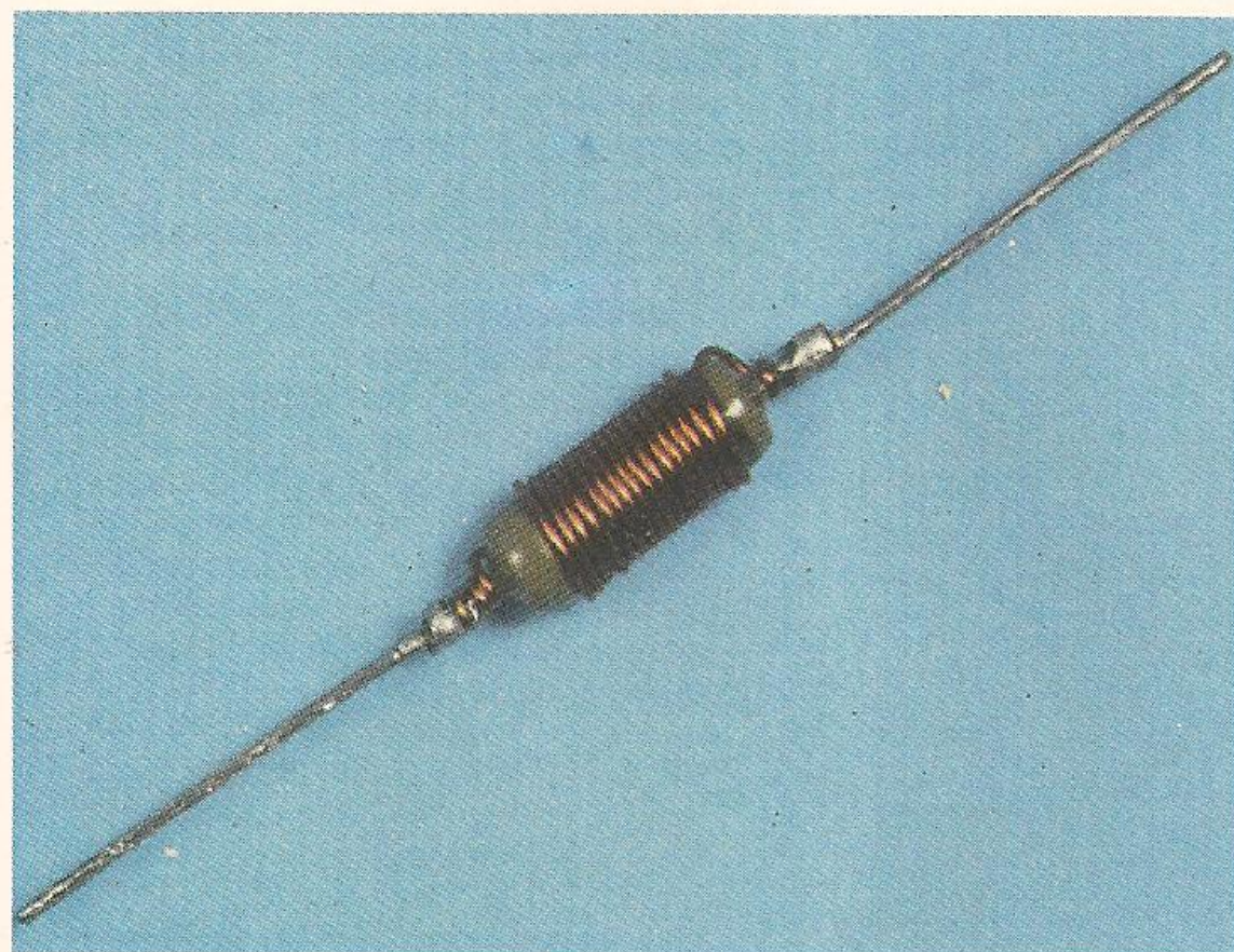
14. Bobina (B1) enrolada sobre o corpo do resistor de 10 K \Omega /1 W.
