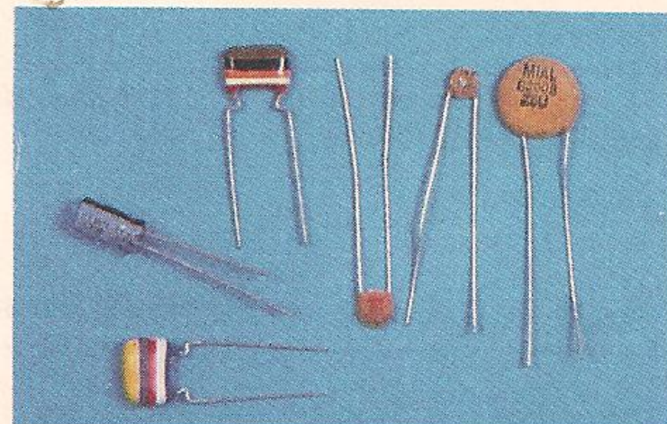
3. Capacitores cerâmicos (C1, C2 e C4), de poliéster (C3 e C5) e eletrolítico (C6).
