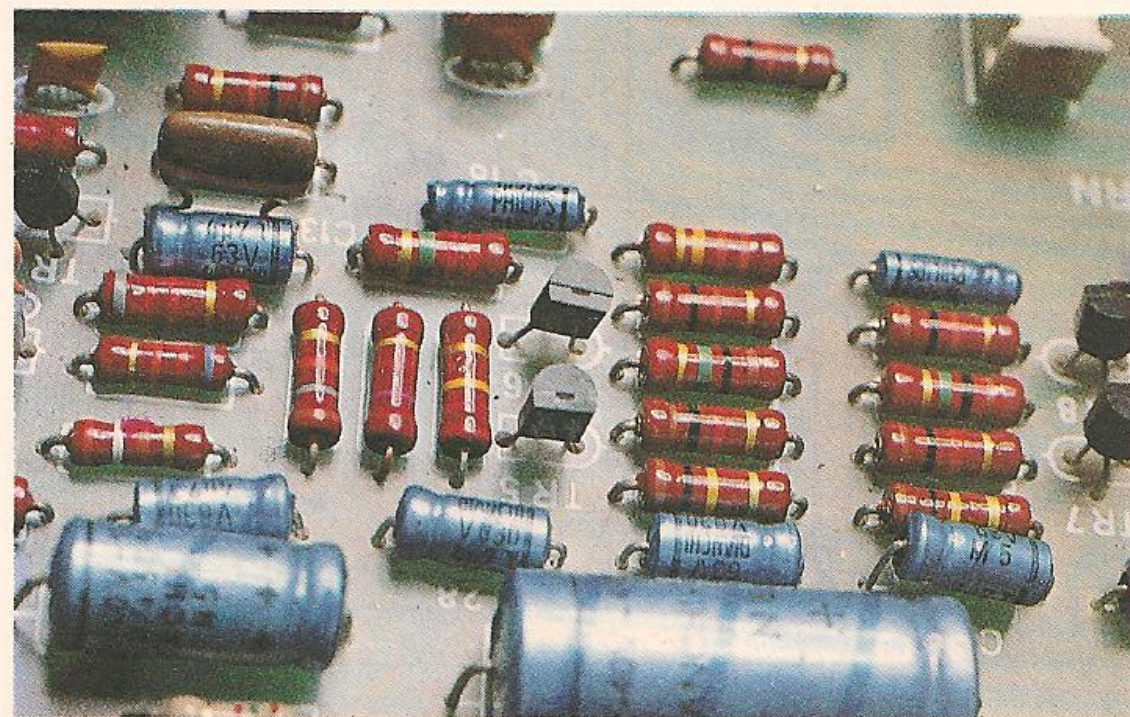
ABAIXO: segundo estágio amplificador de um dos canais do circuito seletor das entradas.
