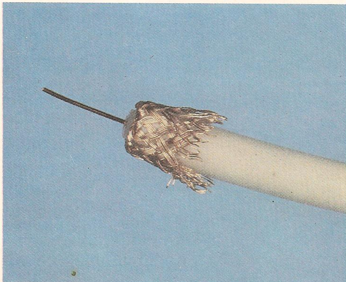
12. Preparação do cabo coaxial para inserção no divisor híbrido.
