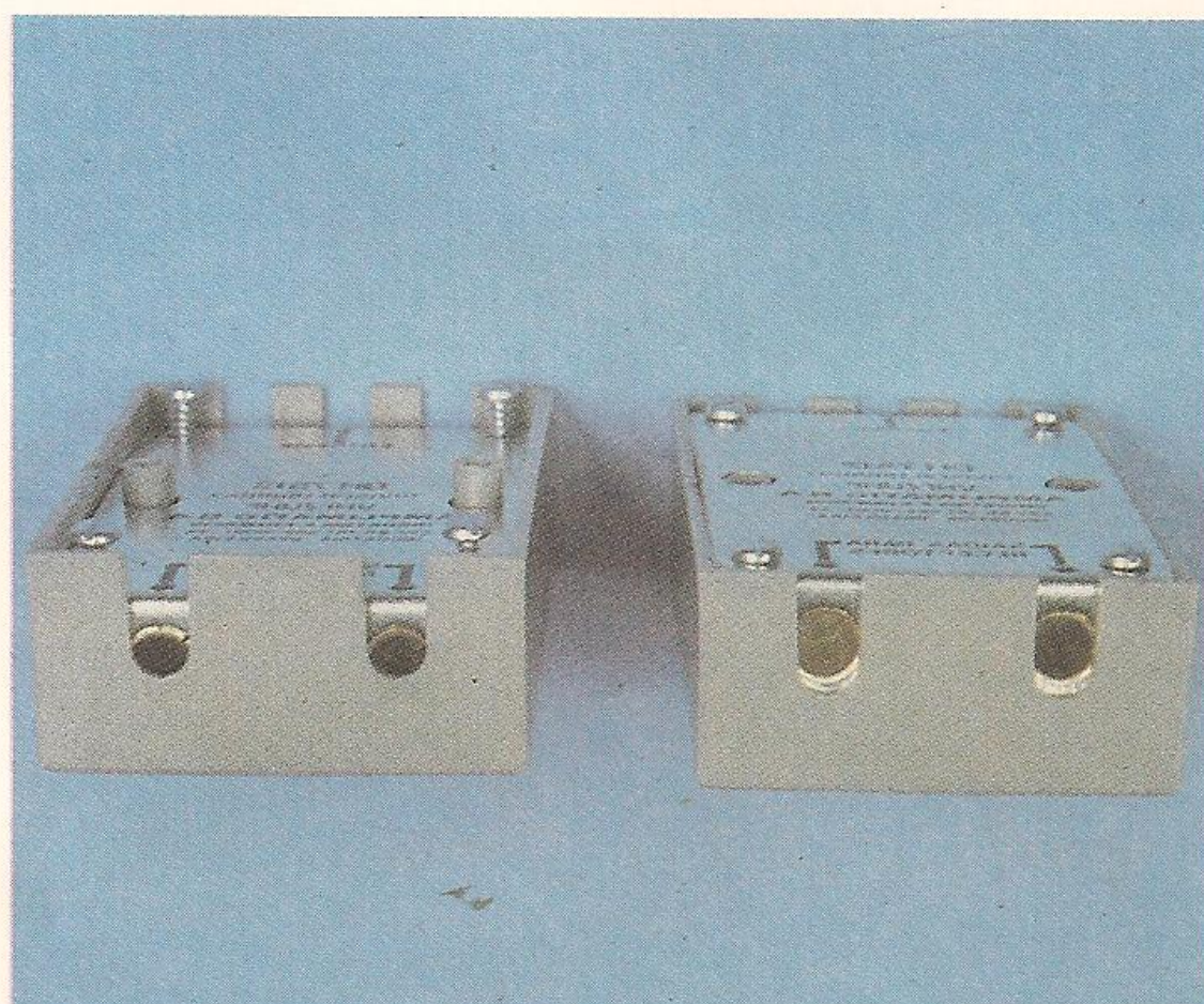
11. Preparação do divisor híbrido para conexão de cabos coaxiais de 75 Ω.
