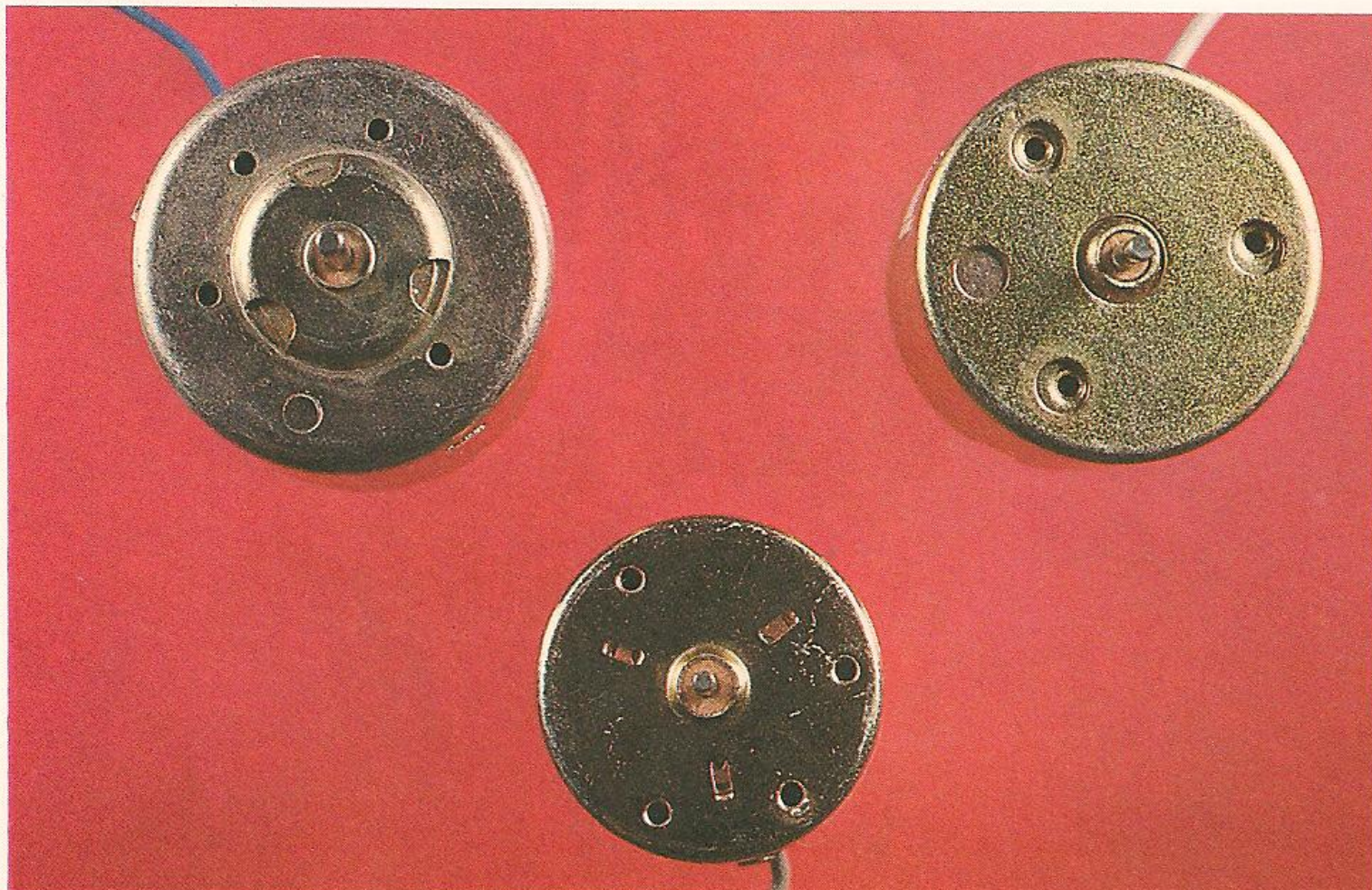
ABAIXO: motores de corrente contínua. Estes modelos são usados principalmente nos toca-discos.
