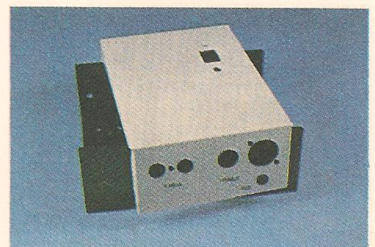
14. Chassi e tampa prontos. No caso de se usar tomada de painel retangular e chave H-H, deve-se modificar os furos.
