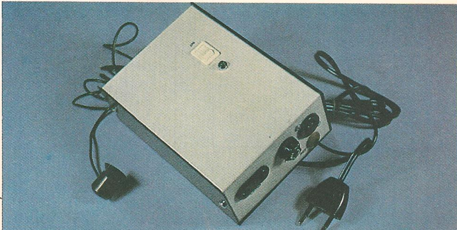
31. Aspecto final do sinalizador remoto montado.
