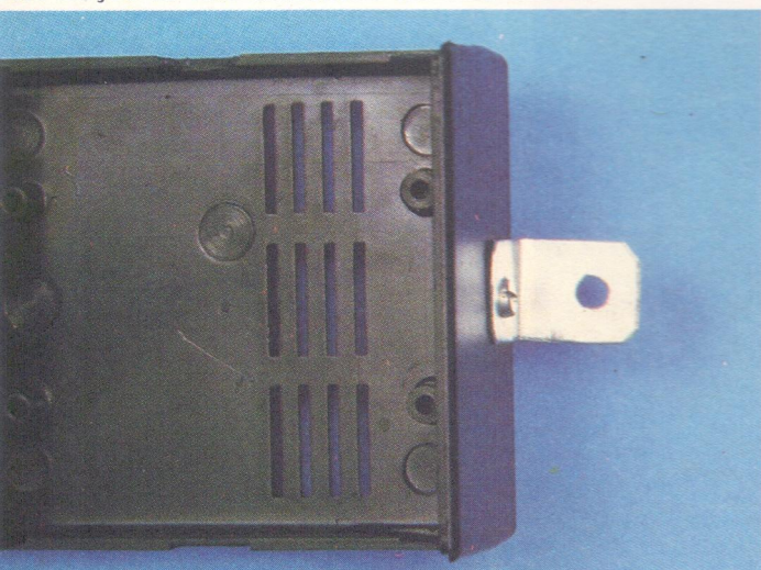
18. Fixação de uma cantoneira em L no chassi.
