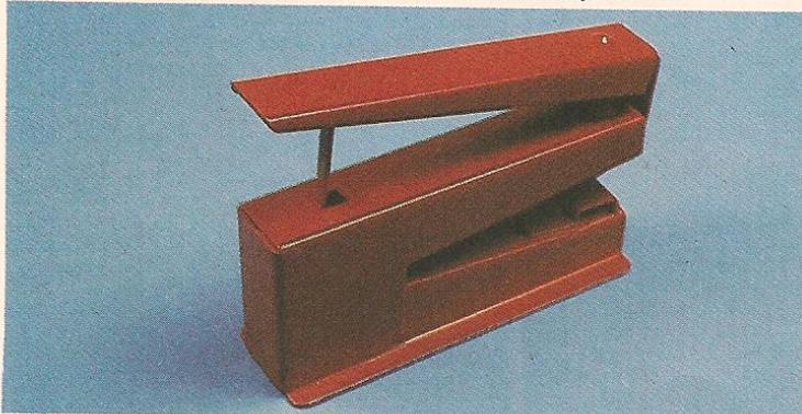
**5. Cortador manual de placas composto de régua para fixação e punção para corte.**
