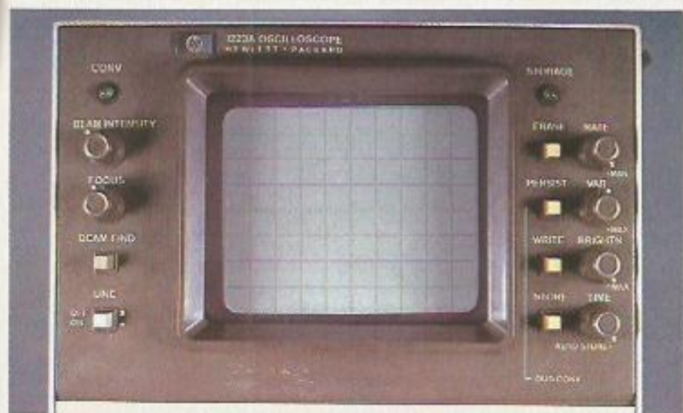
ACIMA: detalhe do visor de um osciloscópio; os comandos dispostos dos dois lados controlam as características da imagem e a persistência.
