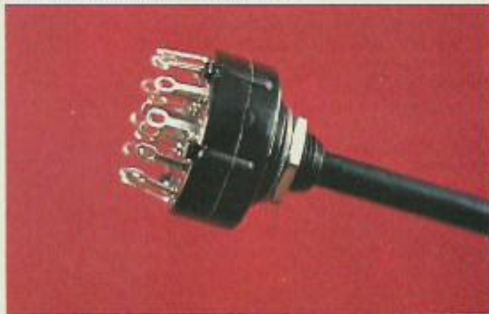
ABAIXO: comutador rotativo. Este é um modelo de três posições com circuitos independentes.
