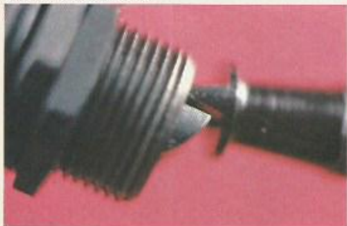
ABAIXO: detalhe do encaixe mecânico de um dos comutadores da ilustração anterior.
