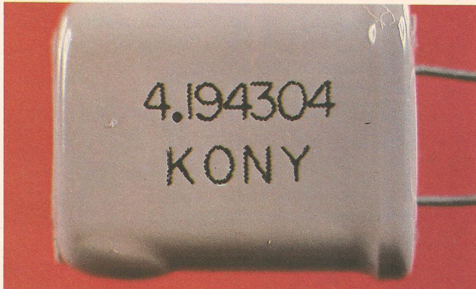
ABAIXO: invólucro de cristal de quartzo com indicação de frequência da operação.
