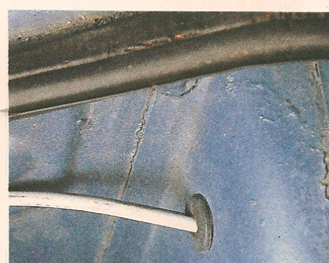
ACIMA: para levar o cabo até o ponto desejado, é indispensável a utilização de uma borracha passa-cabos.
