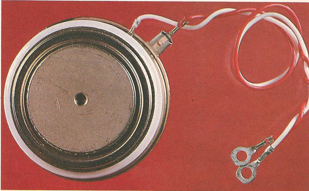
ABAIXO: tiristor de potência do tipo carcaça de pressão.
