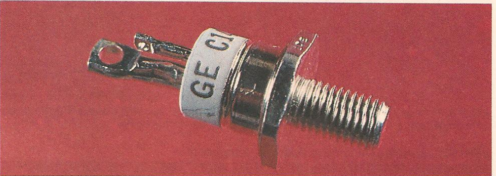
ACIMA: tiristor de média potência pronto para ser montado num radiador.
