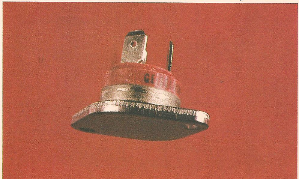
ABAIXO: neste triac, a cápsula pode ser montada em radiadores para T0-3.
