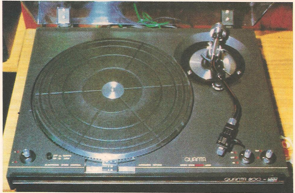
ACIMA: o toca-discos, também chamado simplesmente de prato, é a parte da vitrola que reproduz as informações contidas nos sulcos dos discos fonográficos.
