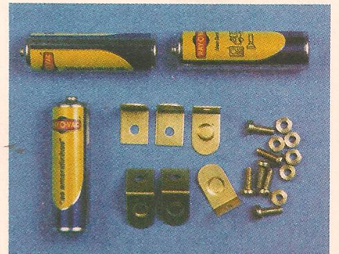
3. Três pilhas pequenas, terminais de contato (três com rebaixo e três com ressalto), parafusos e porcas de fixação.
