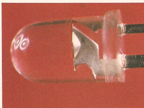
ACIMA: interior de um LED.
