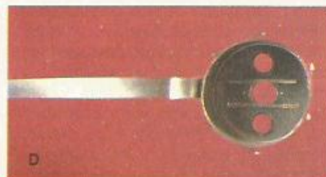
ACIMA: detalhe dos canhões eletrônicos: A) catodos emissores de elétrons; B) grade de controle e grade auxiliar; C) anodo de focalização; D) anodo acelerador com condutor de ligação à camada interna de filme condutor.
