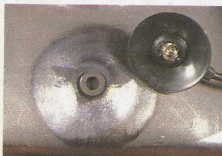
ACIMA: ponto de entrada da alta tensão, com o respectivo cabo dotado de uma ventosa apropriada para a fixação.
