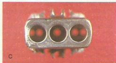
ACIMA: detalhe dos canhões eletrônicos: A) catodos emissores de elétrons; B) grade de controle e grade auxiliar; C) anodo de focalização; D) anodo acelerador com condutor de ligação à camada interna de filme condutor.
