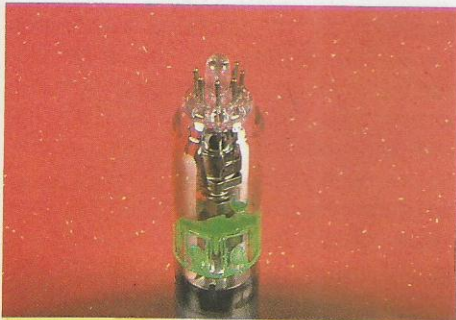
ACIMA: detalhe da extremidade do colo do tubo. Aqui você pode ver os terminais de ligação e o canhão eletrônico.
