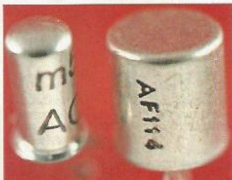
ACIMA: transistores bipolares: de germânio e dotados de carcaça metálica.
