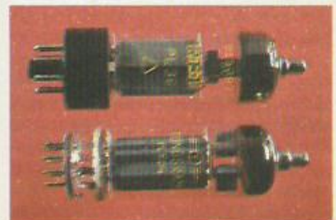
ACIMA: válvulas empregadas em alguns aparelhos no início da década de 70. São os modelos PL36 e PL504 (duplo pentodo), comumente usados nos circuitos em deflexão horizontal.
