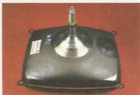
ABAIXO: vista traseira de um cinescópio. O ângulo de deflexão é de 110°.
