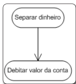
Figura 14. Exemplo de fluxo de controle entre duas ações
