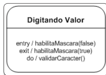
Figura 9. Exemplo de compartimento de transições internas
