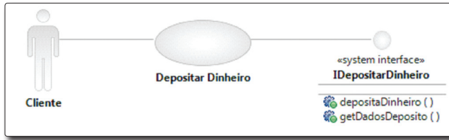
Figura 3. Caso de Uso Depositar Dinheiro e sua system interface
